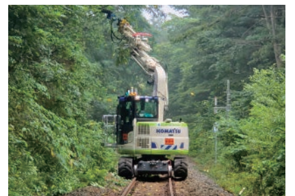
「SLANETRAC HC150」は2〜8tの建設機械に装着する草刈りアタッチメント。調整可能な取り付けブラケットを採用しているので水平から垂直の間の任意の角度で切断できる。線路脇以外でも使用可能で空間を伐採するのに最適だ。
